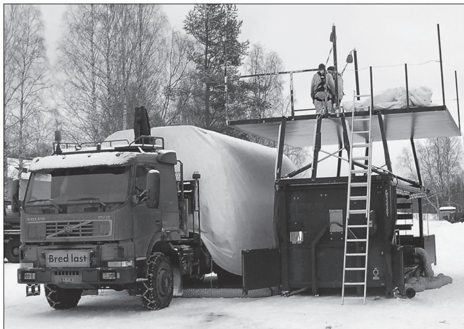
Det nya avisningsflaket med monterade plattform för att underlätta hanteringen av avisningsdukarna.
